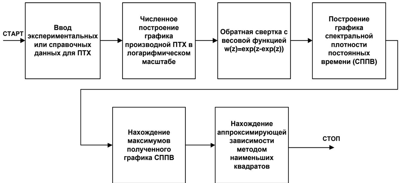
Рис.3.6. Последовательность процедур в составе алгоритма получения аппроксимирующей зависимости
