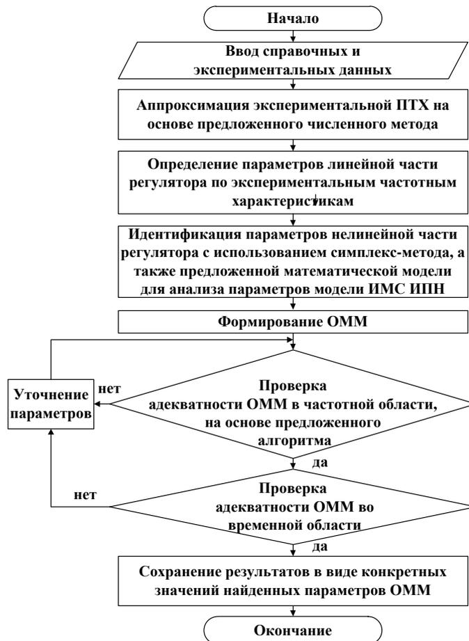
Рис.2.16. Алгоритм интерпретации экспериментальных данных
